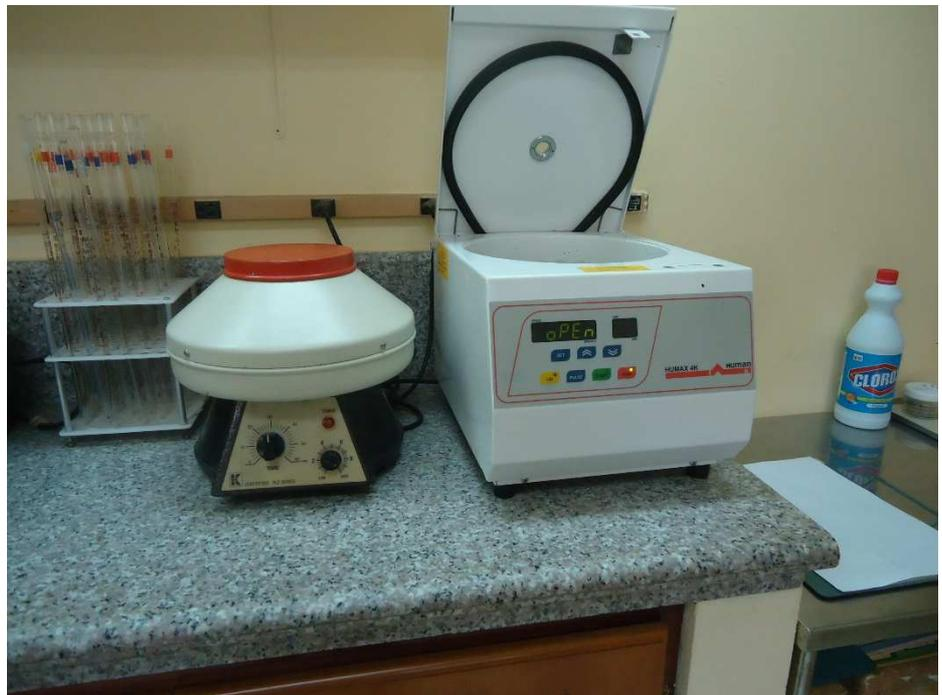
Foto N° 12: Centrífuga, para separación de plasma y
