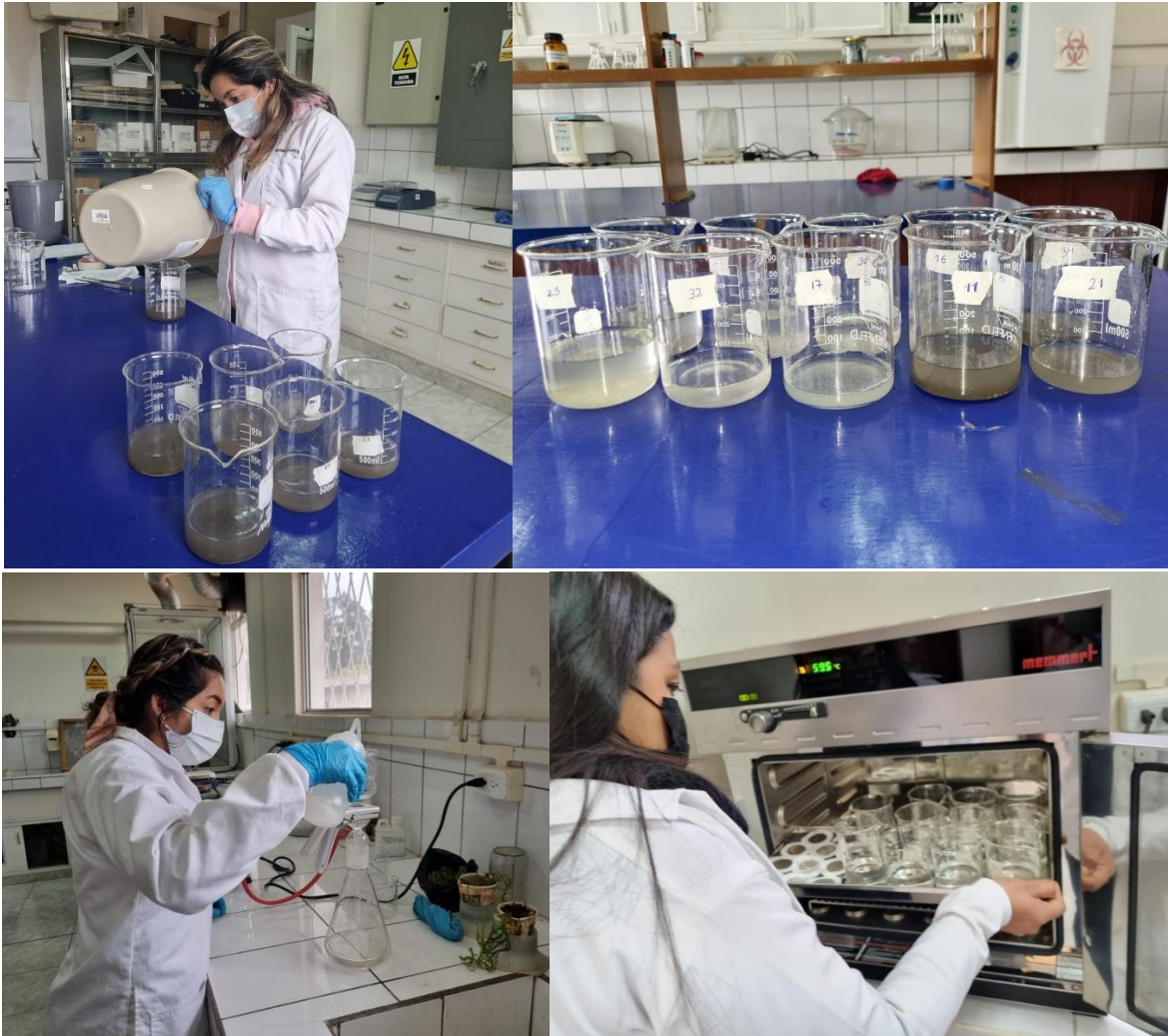
Figura 18. Procedimiento para determinar la cantidad de MPS en el laboratorio.
