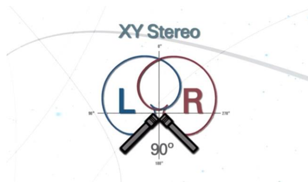
Ilustración 61 Diagrama de captación de audio con técnica estéreo X-Y. Fuente: audio-technica.eu
