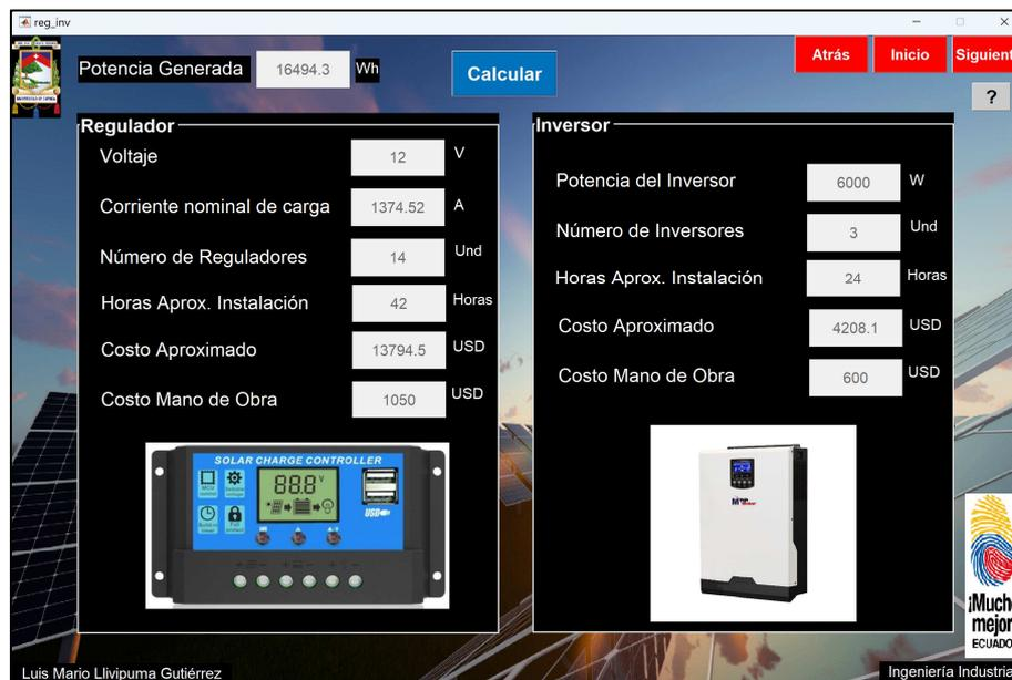
**Ilustración 16:** GUI Regulador e Inversor **Fuente:** Autor.
