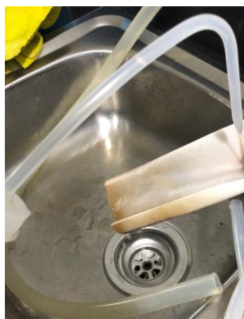
Figura A4.3. Eliminación de extraíbles: (a) Extracción en equipo Soxhlet. (b) Lavado del cartucho. (c) Secado del cartucho en la estufa. Nota: Autoría propia.
