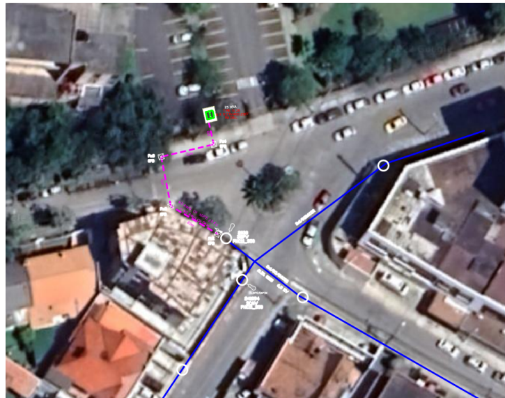
Figura 4.12: Recorrido de la acometida subterránea de MV
