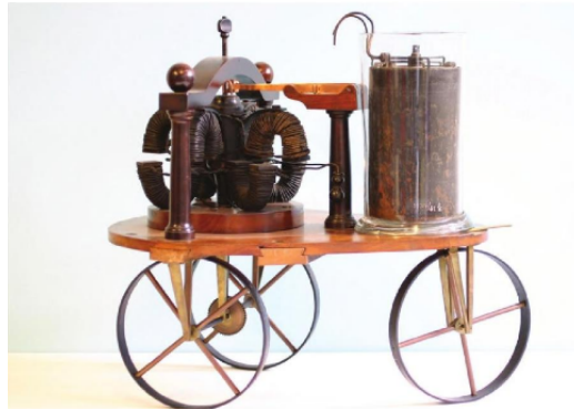
Figura 2.3: Primer carruaje eléctrico, con un banco de baterías. Tomado de [14].
