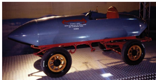
Figura 2.4: Primer auto que rompió la barrera de los 100 km/h e incorporó un diseño aerodinámico. Tomado de [14].
