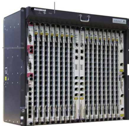
Figura 13. OLT de una red de fibra óptica GPON
