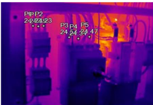
Fig. 3.16. Imagen térmica y RGB. Inversor Supercondensadores.
