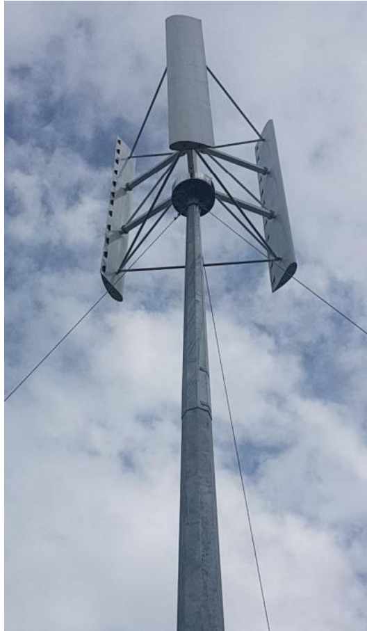
Fig. 2.16. Turbina de eje vertical ubicada en la Granja Iruquis de la Universidad de Cuenca [9]
