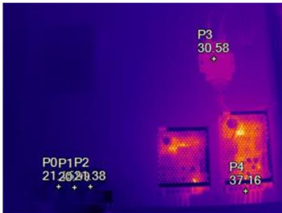
Fig. 3.14. Imágenes térmica y RGB. Inversor de las baterías de Ión-Litio.
