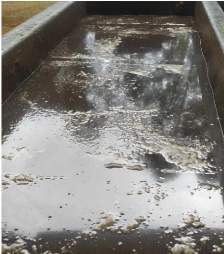
3.1. Agua del proceso de decapado agotada
