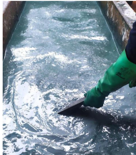
3.2. Proceso de ajuste de pH en cuba de decapado
