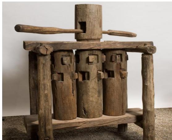
Figura 3 Molino vertical de tres mazas tracción manual.
