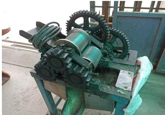
Figura 4 Trapiche impulsado por motor eléctrico
