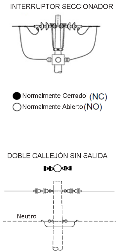
Figura 2.3 Interruptor seccionador para análisis de estado abierto/cerrado de red [12].
