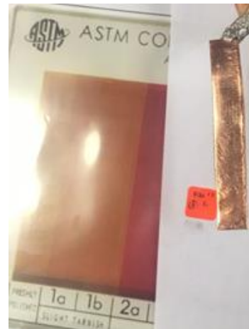
Figura 25. Corrosión al cobre causado por biodiesel obtenido con KOH 1 %. Nota. Autoría Propia.
