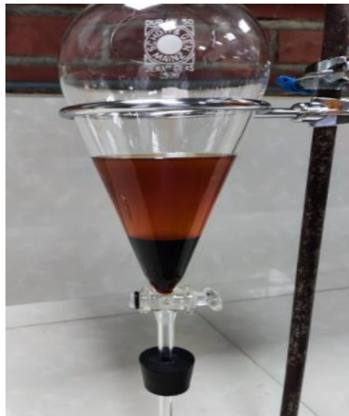
Figura 13. Decantación del biodiesel y glicerina.
