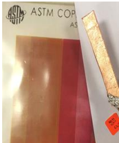
Figura 24. Corrosión al cobre causado por biodiesel obtenido con KOH 0.5 %. Nota. Autoría Propia.
