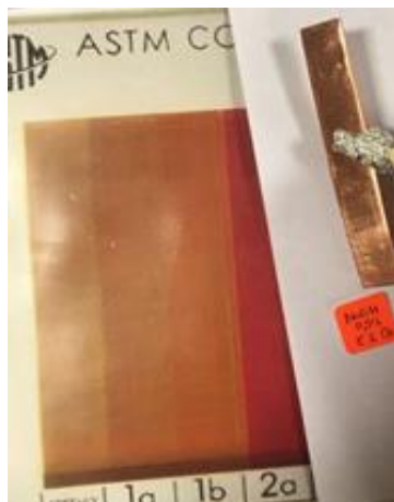
Figura 22. Corrosión al cobre causado por biodiesel obtenido con NaOH 0.5 %. Nota. Autoría Propia.
