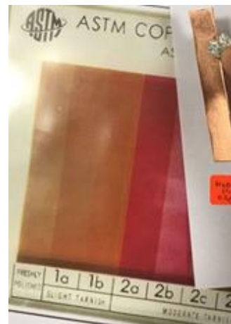
Figura 23. Corrosión al cobre causado por biodiesel obtenido con NaOH 1 %. Nota. Autoría Propia.
