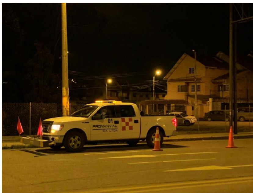
Ilustración 3-5: RSP en medición de IRI, Surco de Huella y Macro textura.
