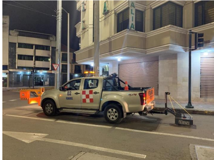
Ilustración 3-15: GPR en medición de espesores de estructura de pavimento con antena de 2GHz y otra de piso de 400 MHz
