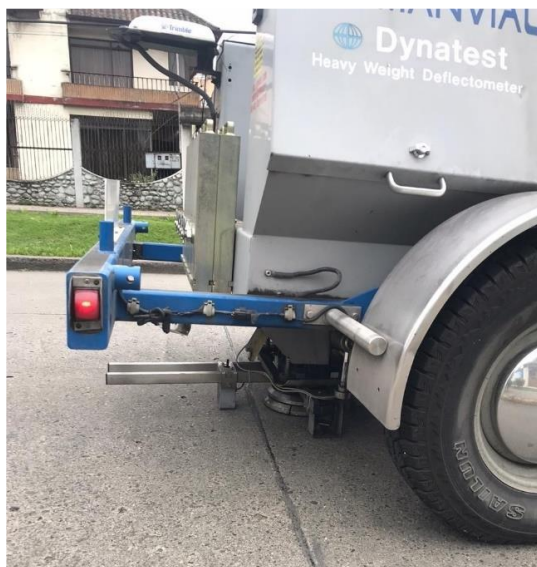
Ilustración 3-13: Heavy Weight Deflectometer - HWD midiendo transferencia de carga.
