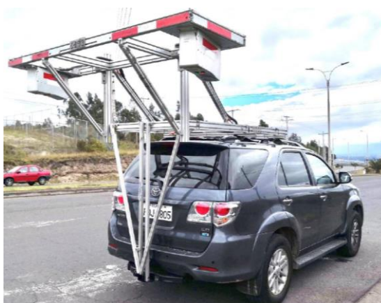
Ilustración 3-12: Vehículo con equipo MFV con tecnología láser 3D en medición de falla. Fuente: (GAD Municipal del Cantón Cuenca., 2021)
