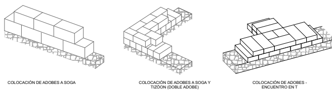
Figura 25. Colocación de adobes en muros Fuente: elaboración en base a Pesantes y González (2011).
