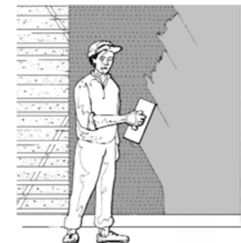
Figura 46. Segunda capa Empañetado afinada Fuente: Carazas y Rivero (2002)
