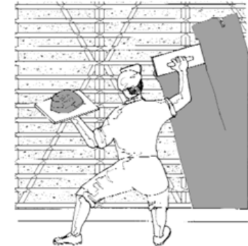
Figura 44. Primera capa empañetado Fuente: Carazas y Rivero (2002)
