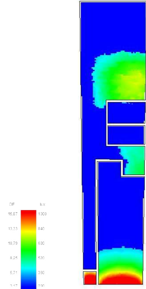
Gráfico 315. Analisis de iluminancia intervención planta baja, Solsticio de Verano 12 horas, Casa Simón Bolívar, 2022 Fuente: Propia
