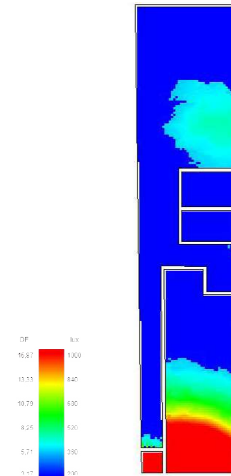
Gráfico 310. Analisis de iluminancia intervención planta baja, Solsticio de Invierno 9 horas, Casa Simón Bolívar, 2022 Fuente: Propia
