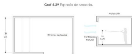
Figura N.13. Esquema diseño cuarto de secado
