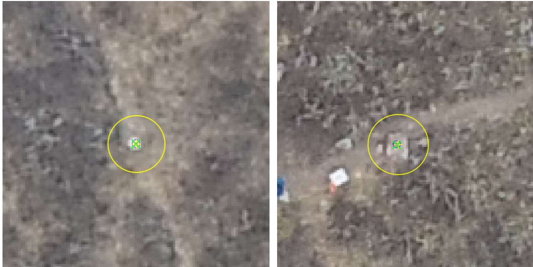
Ilustración 19. Identificación de puntos de control en fotografías tomadas con el dron.
