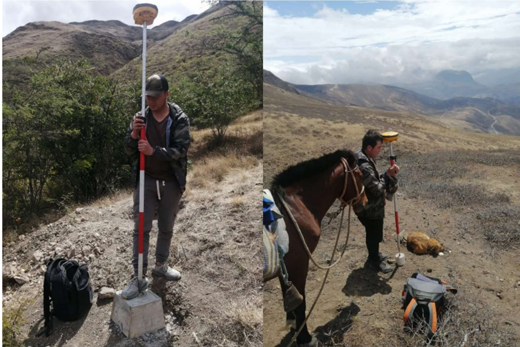
Ilustración 11. Levantamiento de puntos de control mediante RTK
