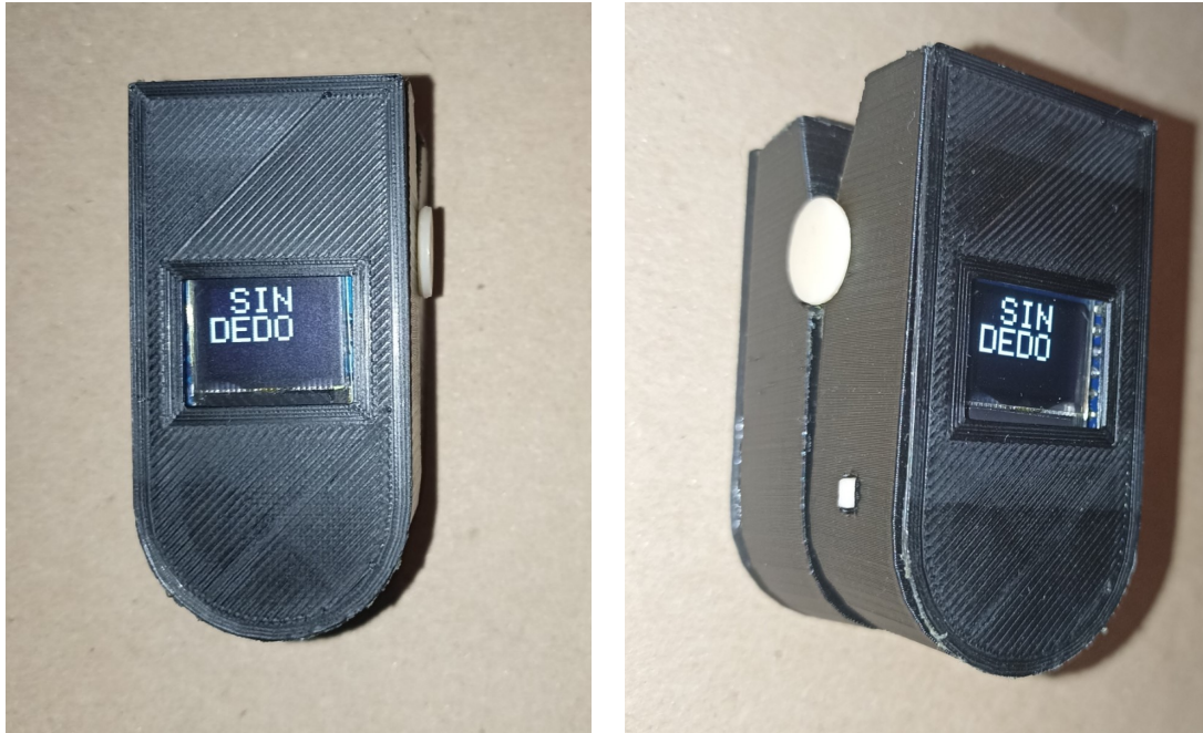
(a) Modelo impreso en 3D del prototipo final con pantalla OLED. (b) Modelo impreso en 3D del prototipo final con botón externo de reinicio.
