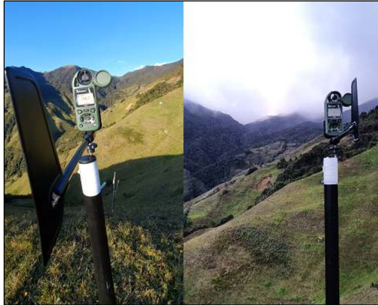
Figura 3.7: Obtención de datos en campo en el sector Oropamba, con el medidor meteorológico Kestrel 5500, se aprecia un día soleado y en día nublado con presencia de lluvia.
