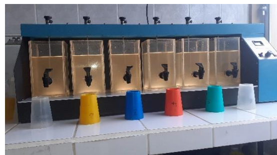
Figura 96. Prueba de jarras con turbiedades bajas Fuente: Autores
