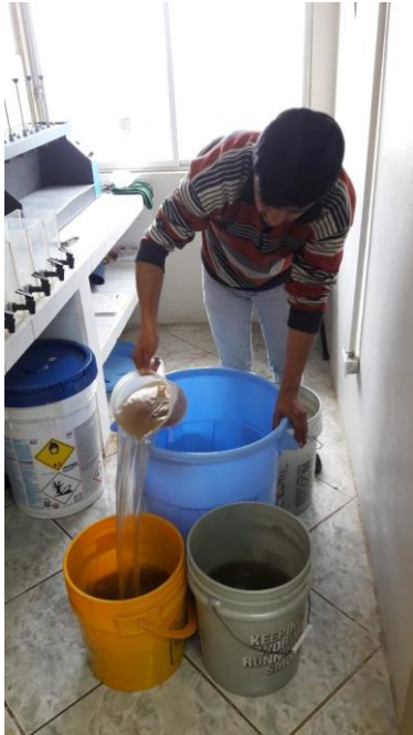
Figura 91. Homogenización de una muestra de agua cruda Fuente: Autores
