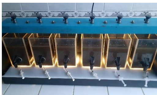
Figura 95. Adición del coagulante PAC Fuente: Autores
