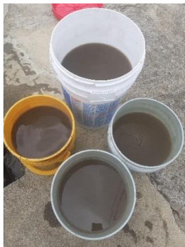
Figura 93. Muestras de agua cruda con turbiedad alta Fuente: Autores
