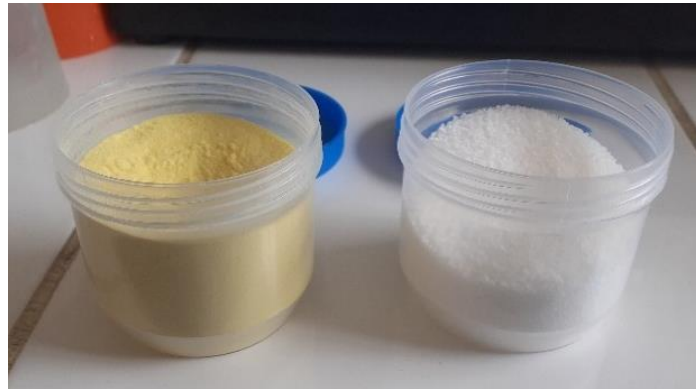
Figura 39. Policloruro de aluminio (izquierda), polímero catiónico (derecha) Fuente: Autores
