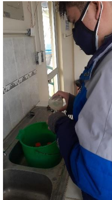
Figura 92. Preparación de celda para medir turbiedad Fuente: Autores
