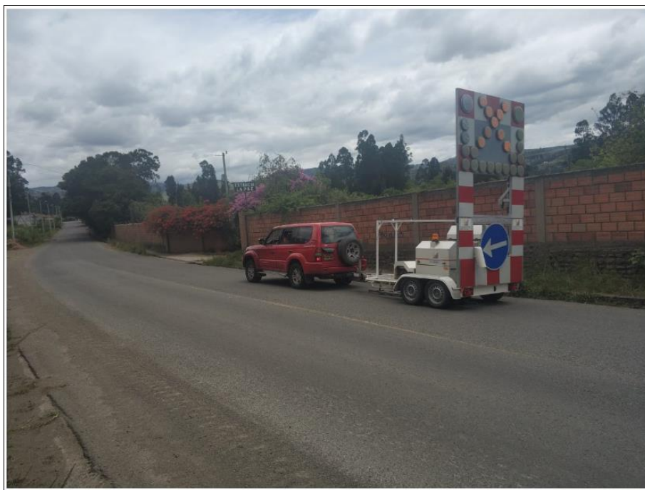
Figura 14. Deflectómetro PRIMAX 1500, ensayo Panamericana Norte ABSCISA 6+170
