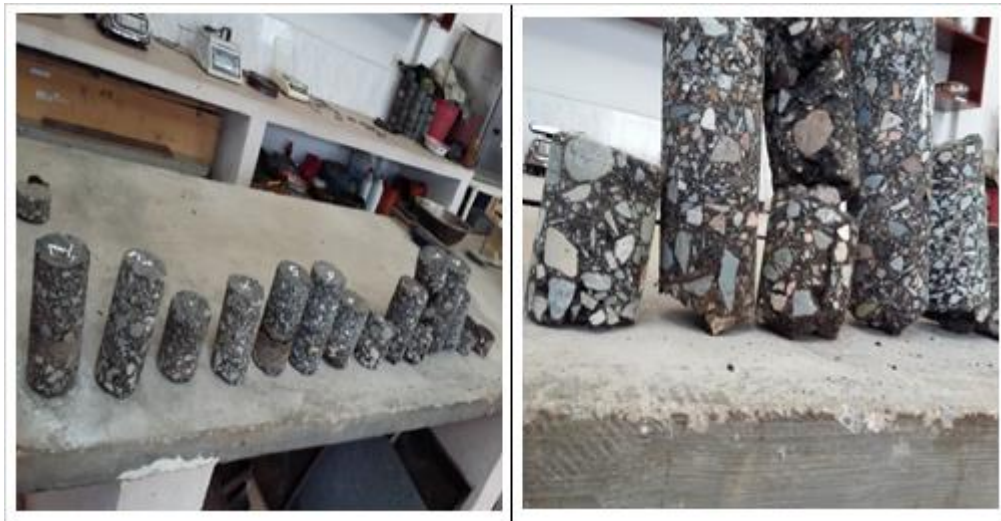
Figura 53. Núcleos extraídos de la carpeta asfáltica
