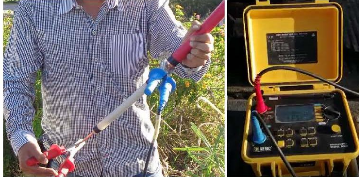
Figura 1. Pruebas de aislamiento del conductor XLPE (sin puntas).
