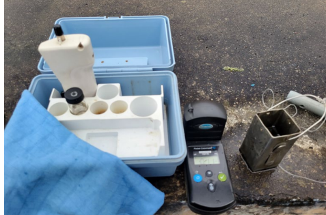
Ilustración 26. Medidor de Cloro Residual
