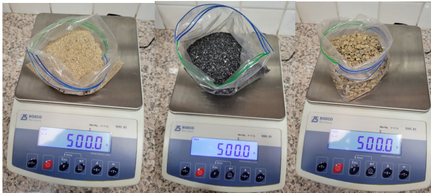
Ilustración 21. Pesado de materiales a usar, Arena, Antracita y Gravilla respectivamente.
