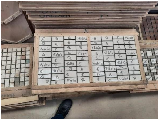
Moldes de armado de 2 mosaicos
