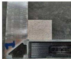
Ilustración 35: Escuadra para medir ortogonalidad del chip
