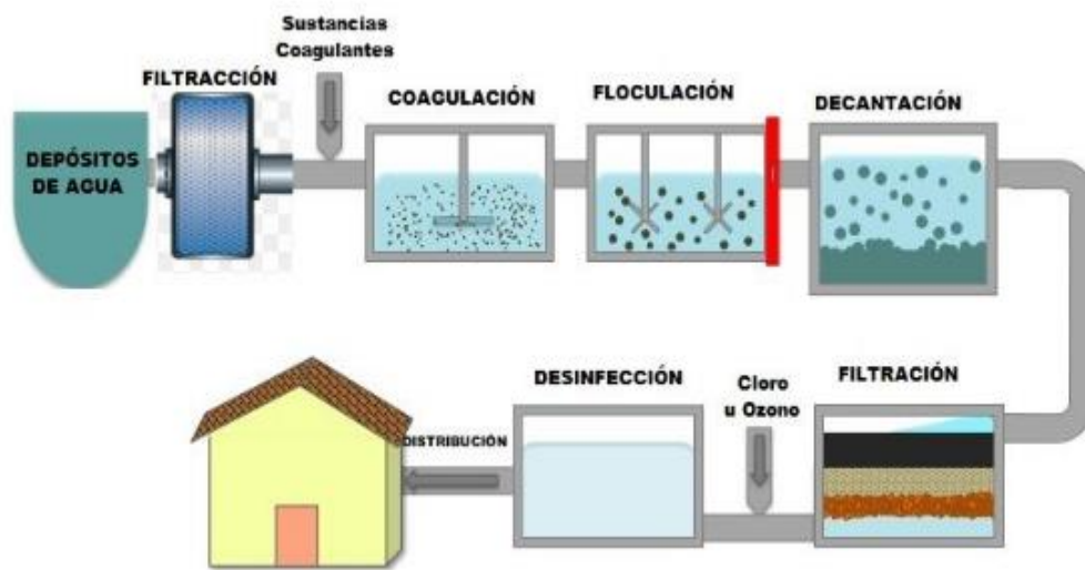
Figura 5. Esquema del Proceso de Potabilización del Agua («Potabilización y Depuración del Agua», 2020).
