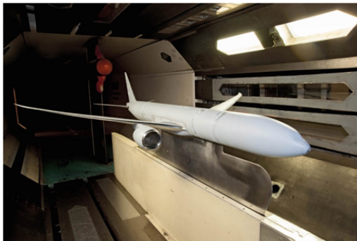
Figura 58. Boeing 777X en el túnel de viento para diferentes fases de vuelo
