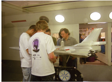
Figura 60. Modelo a escala de un avión en un túnel de viento
