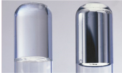
Figura 13. Menisco de agua (izquierda) y mercurio (derecha) en un tubo de ensayo
