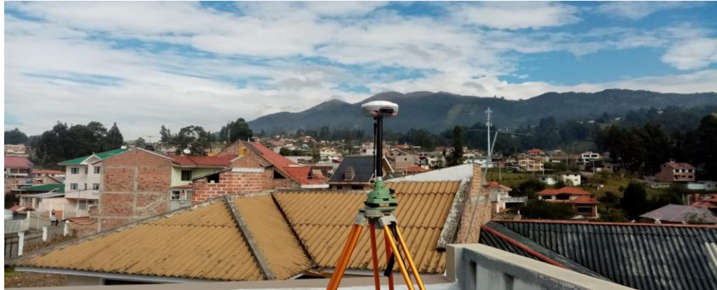
Ilustración 31. Instalación del equipo base.
