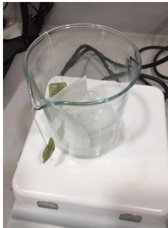
Figura 20: Mezcla de catalizador no soportado con etanol
