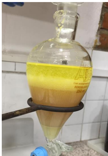
Figura 22: Separación de fases usando catalizador no soportado.
