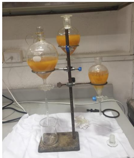
Figura 19: Separación del aceite lavado del agua
