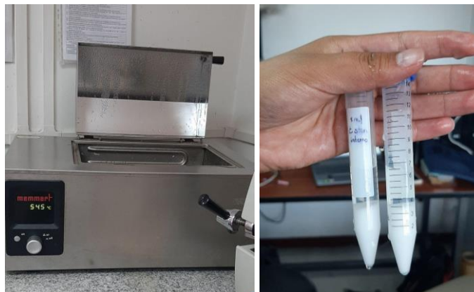
Figura 26: Incubación y enfriamiento de las muestras
