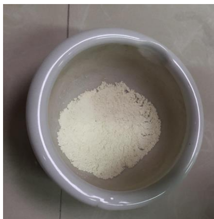
Figura 35: Óxido de cinc obtenido con formación de cristales de sulfato de cinc.
