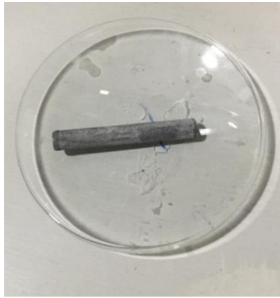
Figura 18: Barras de carbón impregnada con óxido de cinc
