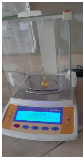
Figura 32: Medición de la densidad de las muestras.
