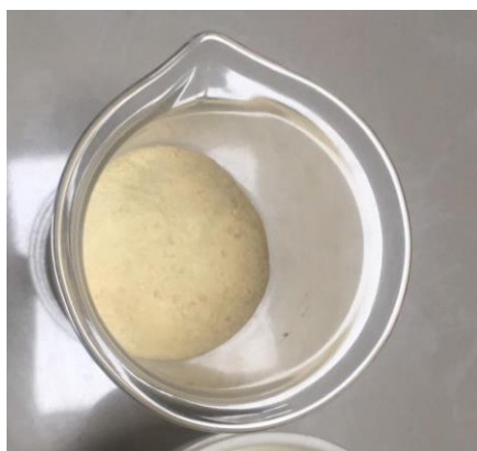
Figura 36: Óxido de cinc obtenido sin formación de cristales de sulfato de cinc
