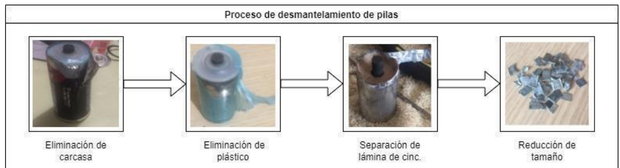
Figura 10: Desmantelamiento de pilas
