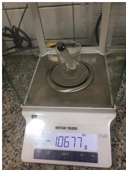
Figura 30: Cantidad de muestra de aceite inyectada
