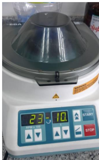
Figura 27: Centrifugación de las muestras
