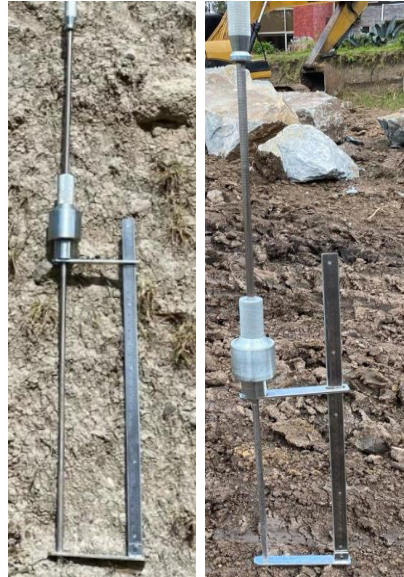
otografía 3-1 Equipo DCP utilizado en el estudio.
