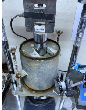
Fotografía 3-3 Presa con pistón de penetración para ensayo CBR
