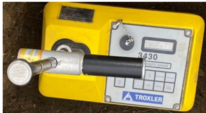
Fotografía 3-2 Densímetro nuclear utilizado en el estudio
