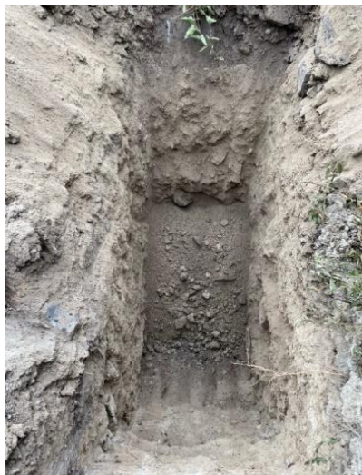
Ilustración 15 Calicata #4 Fuente: Juan Vanegas
