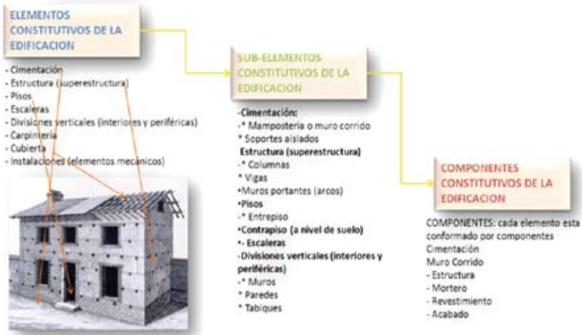
FIG. 07 MODELO ANALÍTICO DE LA EDIFICACIÓN. ARCHIVOS PROYECTO vllr/CPM. JUNIO 2011.
