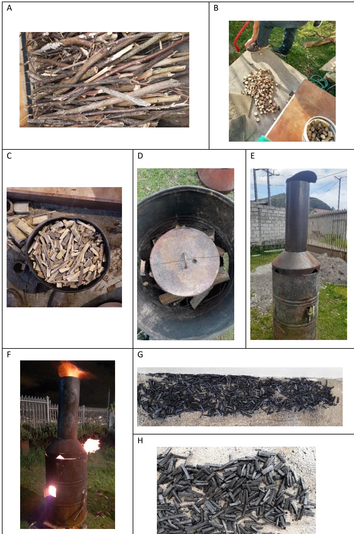
Figura 46. Proceso productivo del bio carbón. A: Leña para combustible B: Preprocesamiento de biomasa para bio carbón (cortado). C: Cámara interna de reactor. D: Configuración de cámara externa de reactor. E: Reactor armado para pirólisis. F: Reactor al momento de la pirólisis. G y H: Post procesamiento de bio carbón (secado)
