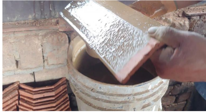
Ilustración 8: Vidriado de tejas. Fuente: Elaboración propia
