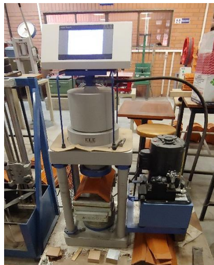
Ilustración 17: Equipo de ensayos de resistencia a la flexión y compresión del laboratorio de Construcciones y Aplicaciones Bioclimáticas de la Universidad de Cuenca. Fuente: Elaboración propia
