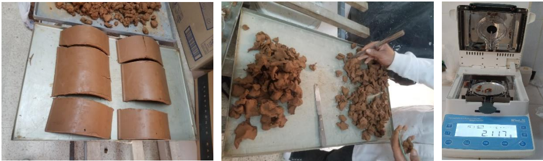
Ilustración 14: Método de determinación de humedad mediante termobalanza. Fuente: Elaboración propia
