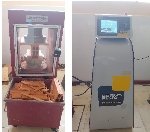
Ilustración 18: Equipo de ensayos de Compresión de la Universidad Politécnica Salesiana de Cuenca. Fuente: Elaboración propia
