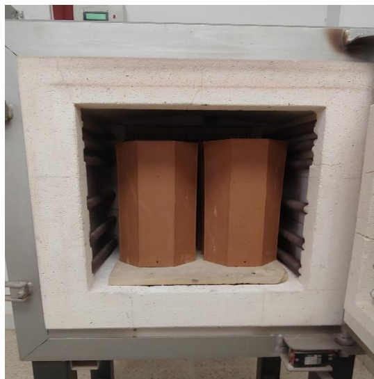
Ilustración 7. Cocción de tejas en horno de laboratorio. Fuente: Elaboración propia
