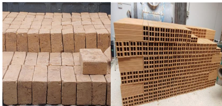
Ilustración 2. Ladrillos macizos y huecos secos. Fuente: Elaboración propia
