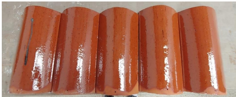
Ilustración 9: Tejas tipo curva vidriadas en el laboratorio. Fuente: Elaboración propia
