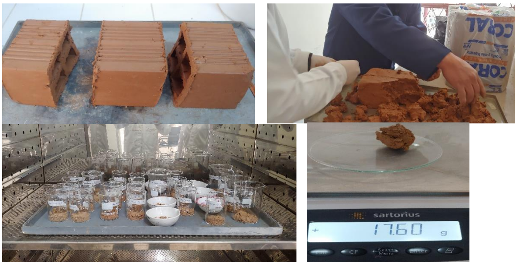
Ilustración 15: Método de determinación de humedad mediante estufa. Fuente: Elaboración propia
