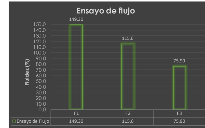
Gráfico 4.3: Resultado de ensayo de flujo de las muestras F1, F2 Y F3. Fuente: (Orellana & Sánchez, 2021). Elaboración: propia
