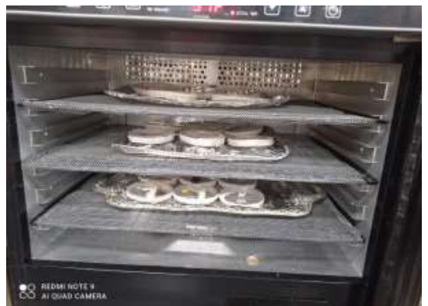
Imagen 14. Etapa de secado en método de Winnick.
