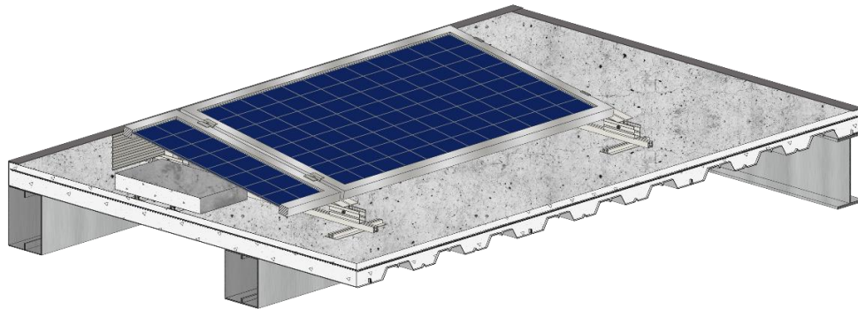
Figura 4-50 Detalles constructivos en 3D y 2D de sistema auto portante
