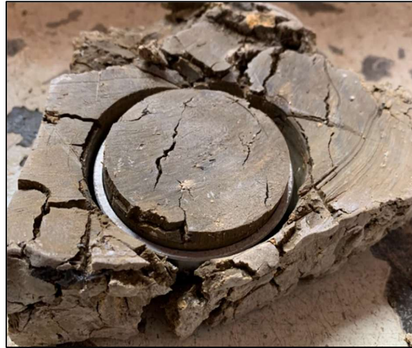
Figura 40. Obtención de muestra inalterada de Challuabamba en anillo en laboratorio.
