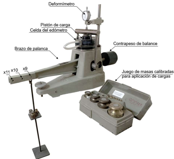
Figura 20. Edómetro armado para un ensayo de presión de expansión.
