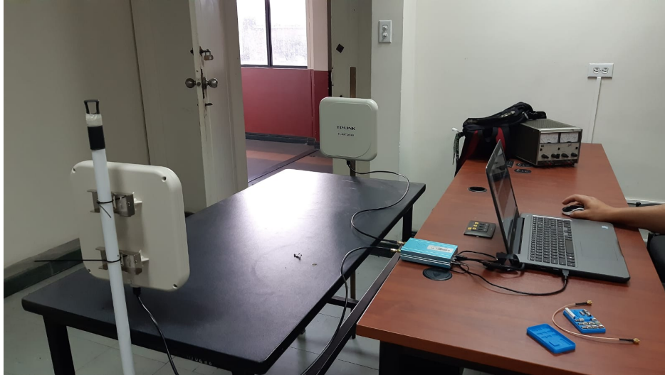
Figura C.1: Medición de ganancia de las antenas TP-Link con el VNA
