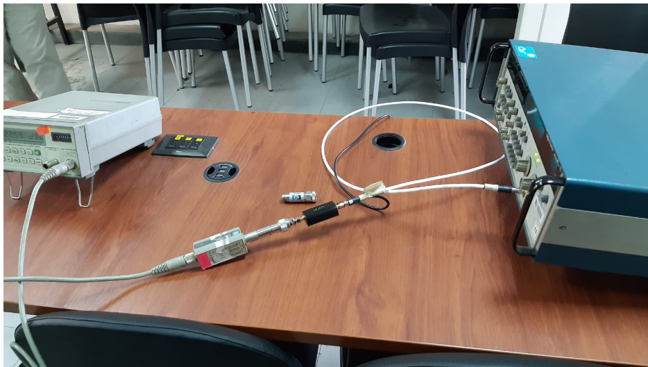
Figura C.2: Medición del amplificador lineal NooElec Lana en el laboratorio
