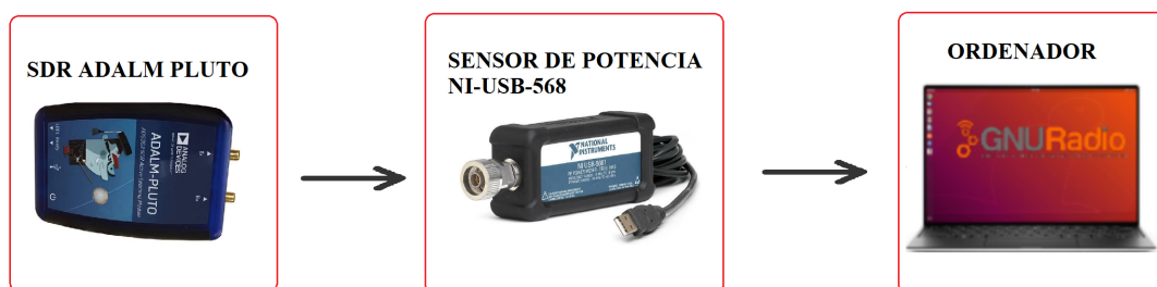
Figura 4.1: Esquema para la medición de potencia de transmisión del Adalm Pluto con un sensor NI-USB-568
