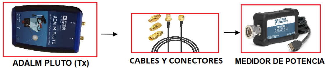
Figura 4.14: Esquema para encontrar el valor de pérdida de cables y conectores
