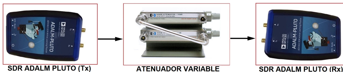
Figura 4.5: Esquema utilizado para obtener las características de respuesta del receptor del SDR Adalm Pluto
