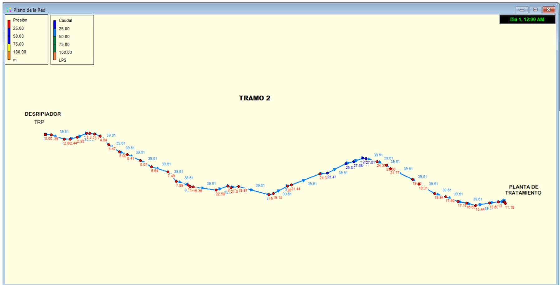
Ilustración 35: Modelo unidimensional de flujo para el caudal actual requerido, se muestra en las tuberías el caudal y en los nodos la presión del sistema. Realizado en EPANET 2.0
