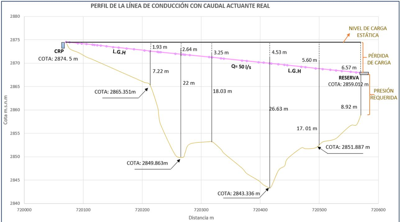
Figura 4: Línea de gradiente hidráulico para el caudal actual real de la línea de conducción. Elaboración: Autoras.
