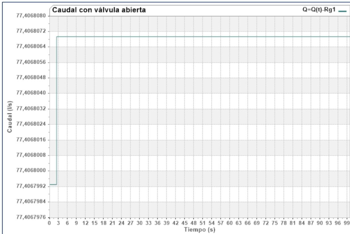
Figura 7: Caudal para un escenario con válvula completamente abierta Fuente: ALLIEVI Elaboración: Autoras
