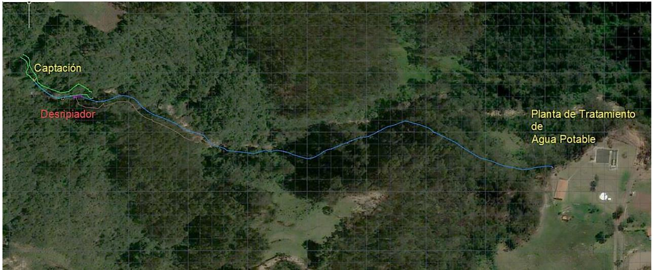
*Ilustración 27 Levantamiento topográfico final de la línea de conducción Elaboración: Autoras*
