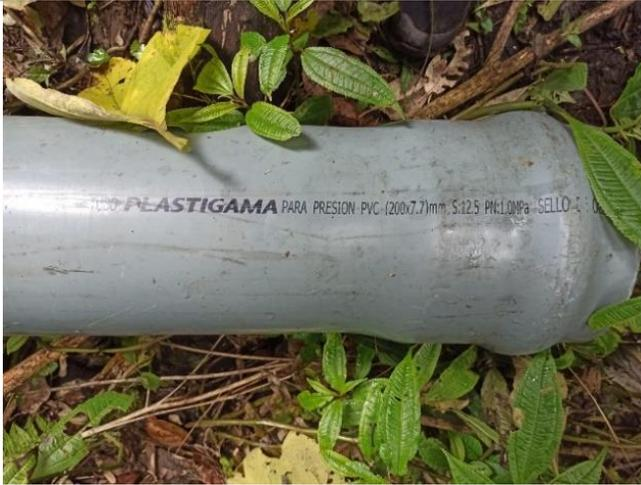
Ilustración 25: Leyenda de la tubería.
