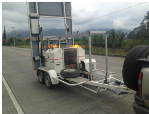
Ilustración 22. Deflectómetro de Impacto del Ministerio de Transporte y Obras Públicas (Abad & Sangurima, 2018)
