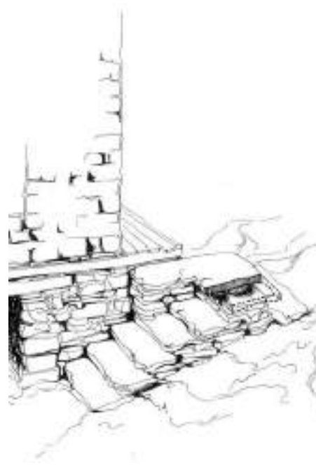
Figura 2. Azuay, Baños. Sistema de aparejo en elementos de piedra en escaleras para adaptarse al relieve del terreno.
