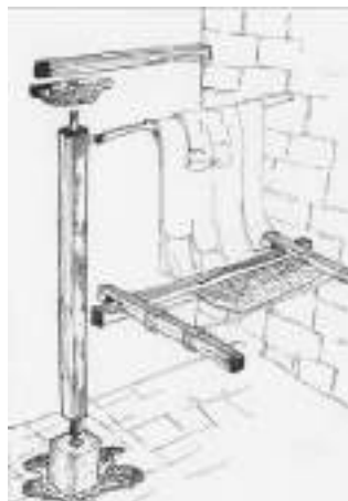
Figura 8. Cañar, Chorcopte. La estructura del telar, es parte de la estructura de la casa.
