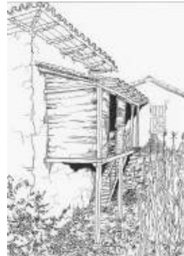
Figura 5. Azuay, Gualaceo. Extensión de la vivienda a través de adaptación de estructura de madera.
