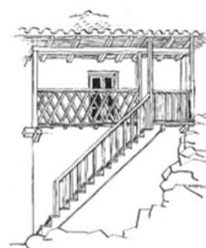
**Figura 26:** VALOR TÉCNICO/ECONÓMICO. Arte y oficio del trabajo de estructura y carpintería en madera. Diseño, modulación e integración de enrejados, escaleras y estructura de en dos plantas (Rivera, Cañar).
