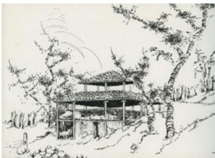
**Figura 8:** VALOR TÉCNICO/ECONÓMICO. Edificación de formas ligeras y transparentes para elaboración de ladrillos adaptada a un entorno agrícola y a desnivel. Estructura constructiva en madera y bahareque (Cuenca, Azuay).
