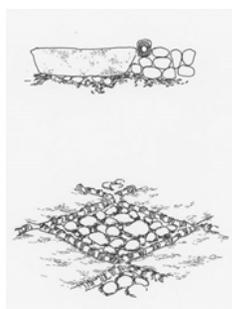
**Figura 24:** VALOR ESTÉTICO/TÉCNICO. Revestimiento de piso, conocido como emorrillado de piedra con diseño geométrico y uso de huesos de animales como elementos de ornamentación (Azogues, Cañar).
