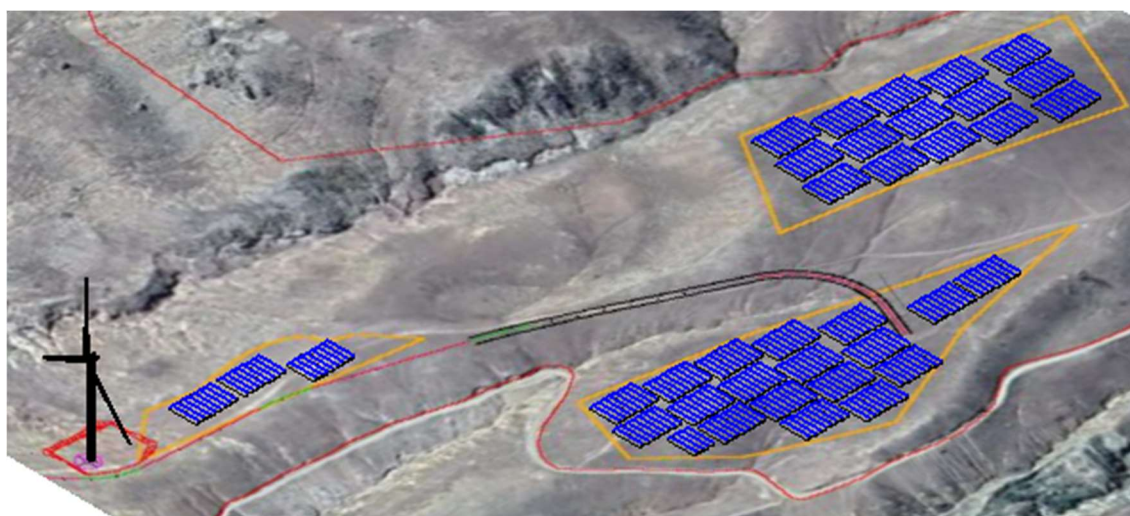
Figura 4.14 Simulación de sombras en superficie 2 con sistema fotovoltaico y aerogeneradores en PVsyst. [Elaboración propia]
