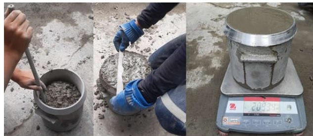
Figura 35. Proceso para determinar la densidad del hormigón.
