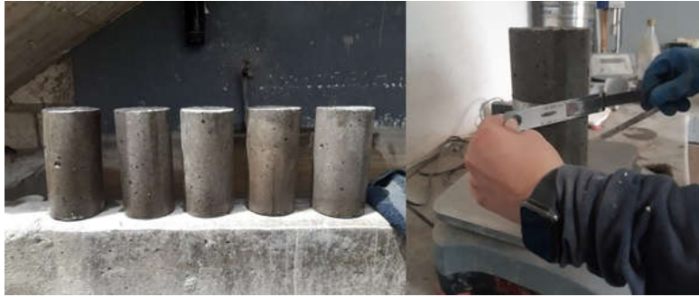
Figura 29. Cilindros recién sacados de la piscina, secados superficialmente, pesados y medidos.
