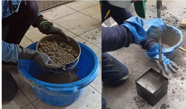
Figura 31. Preparación de la muestra, tiempos de fraguado.
