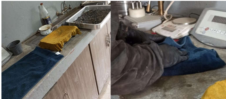
Figura 7. Eliminación de la humedad superficial del árido grueso.
