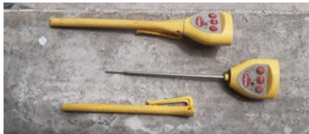
Figura 14. Termómetro de hormigón.
