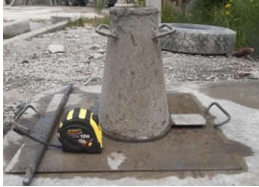
Figura 12. Equipo para toma de asentamiento.
