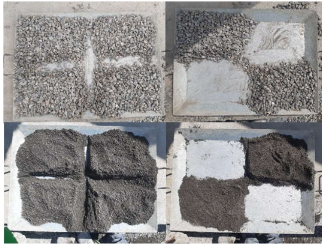
Figura 3. Proceso de cuarteo de los áridos fino y grueso.
