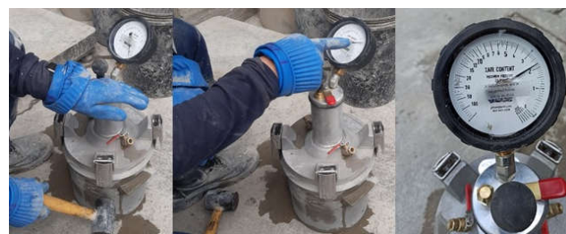
Figura 36. Proceso para determinar el contenido de aire.
