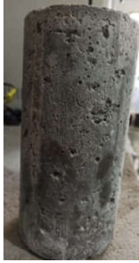
Figura 42. Probetas porosas desmoldadas a las 48 horas.
