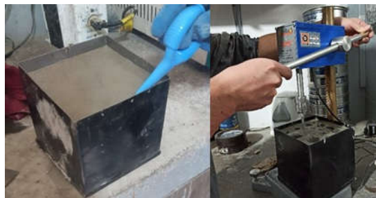
Figura 32. Toma de lecturas de penetración para tiempos de fraguado.
