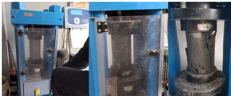
Figura 30. Rotura del cilindro en la máquina de compresión.
