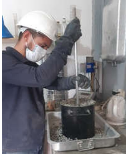
Figura 8. Compactación del árido grueso por el método de varillado.
