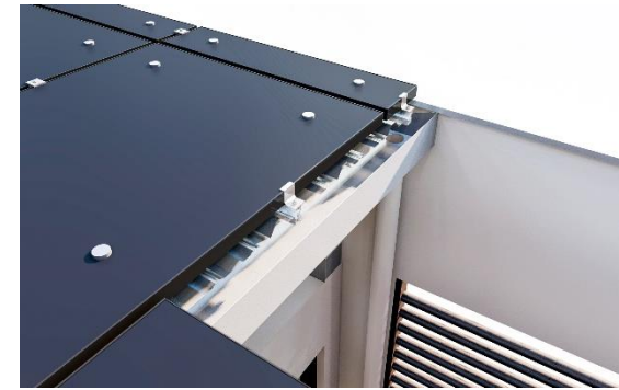
Figura 4.28: Detalle del bajante de aguas lluvias en el patio interior Elaboración: Propia
