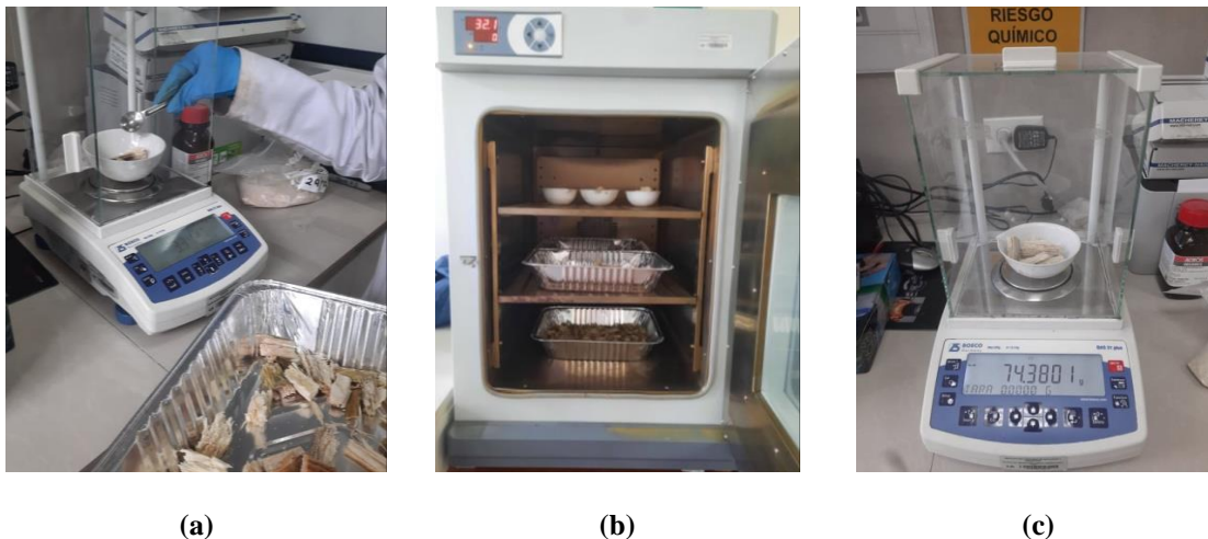
Figura 25. Proceso para la determinación de Humedad: (a) Pesaje de la biomasa. (b) Colocación de las muestras en la estufa. (c) Toma del peso de la muestra seca para determinar el porcentaje de humedad. Fuente: Autor.
