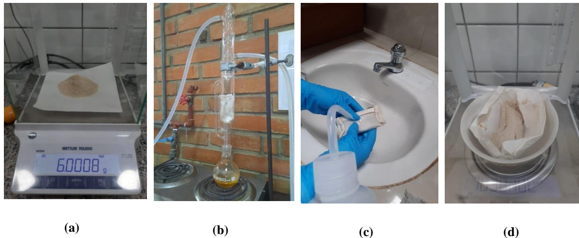
Figura 26. Proceso para la eliminación de extractivos: (a) Peso de la muestra inicial. (b) Extracción en el equipo Soxhlet. (c) Lavado del cartucho. (d) Muestra libre de extractivos.
