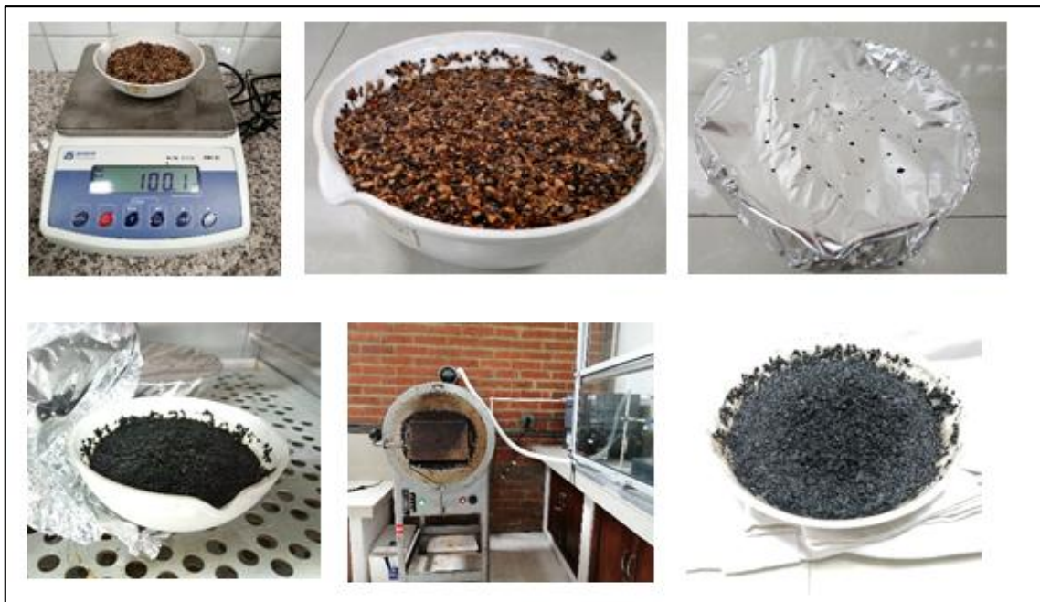
Ilustración 17: Proceso de Activación del Carbón Activado con H_3PO_4 al 85%
