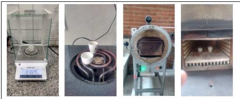
Ilustración 15: Determinación de Cenizas del Cuesco de Nogal
