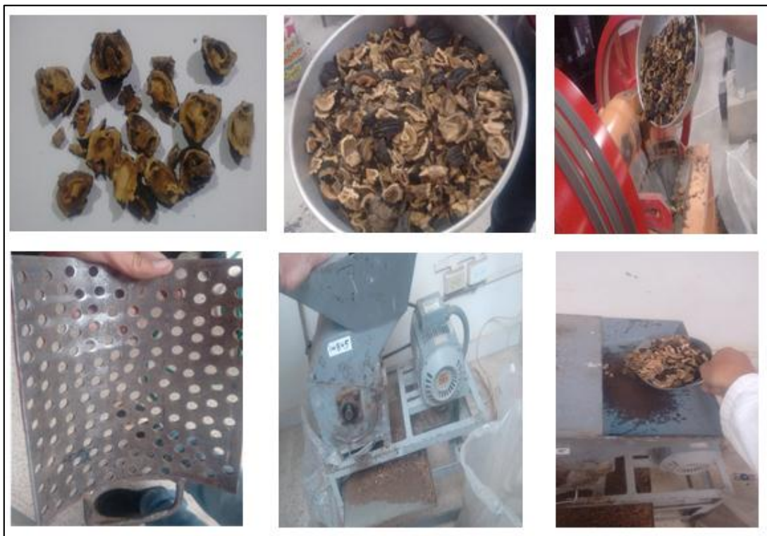
Ilustración 13: Proceso de molienda del cuesco de nogal
