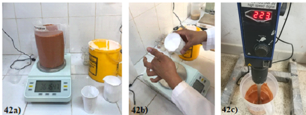
Figura 42 Fotos de preparación de pintura : cuantificación de sólidos en la mezcla del pigmento filtrado 42a), dosificación de aglutinante 42b), mezcla de pigmento- aglutinante 42c).
