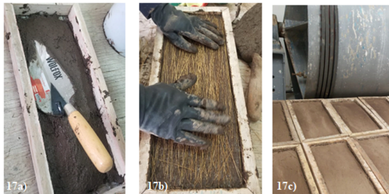
Figura 17 Fotos del proceso: adición de revoque en el soporte 17a), Adición de paja 17b), primera capa terminada y puesta a secar 17c).
