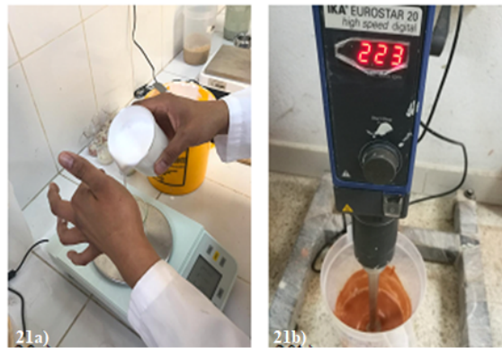
Figura 21 Fotos del proceso: Dosificación de aglutinante 21a), Mezcla pigmento – aglutinante 21b). Fuente: Los autores
