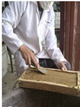
Figura 18 Foto del proceso: Adición de pañete.
