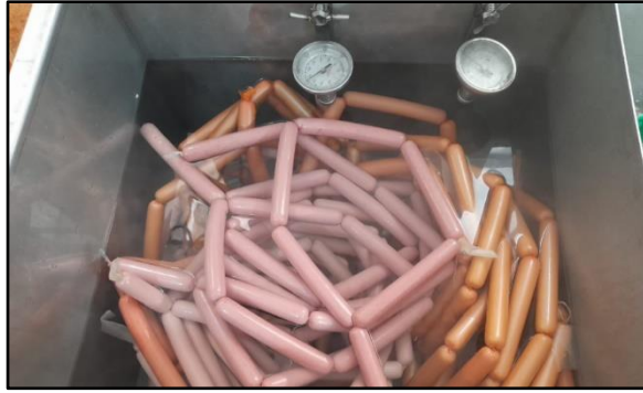
Ilustración 18. Proceso de escaldado de las salchichas.
