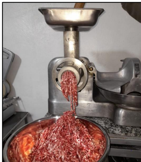
Ilustración 13. Proceso de molido de carne y grasa.
