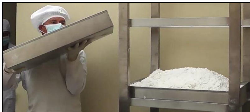
Ilustración 7. Colocación del almidón en mesas para el proceso de secado.
