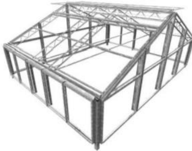
Figura 1. Invernadero de capilla.
